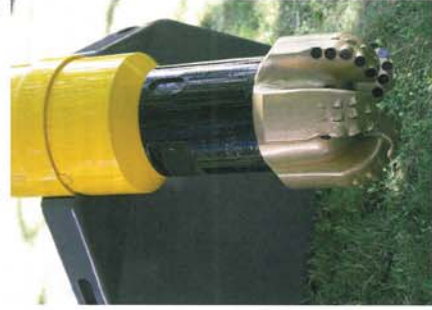
Solche Bohrmeißel sollen den Weg durch den gut erkundeten Untergrund bahnen.
